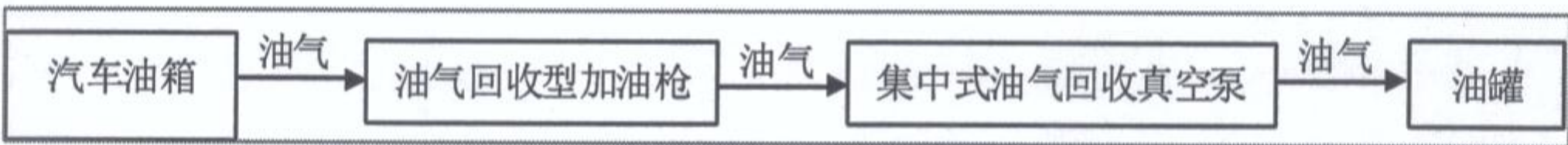
加油油气回收工艺流程图
