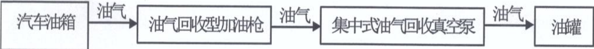
加油油气回收工艺流程图
