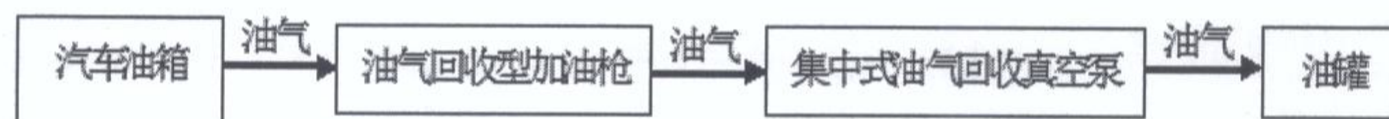
图 4 加油油气回收工艺流程图
