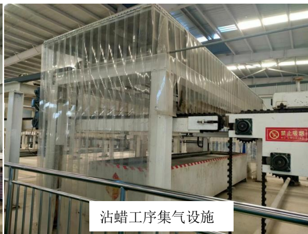
浸漆、烘干工序封闭操作间及集气措施
